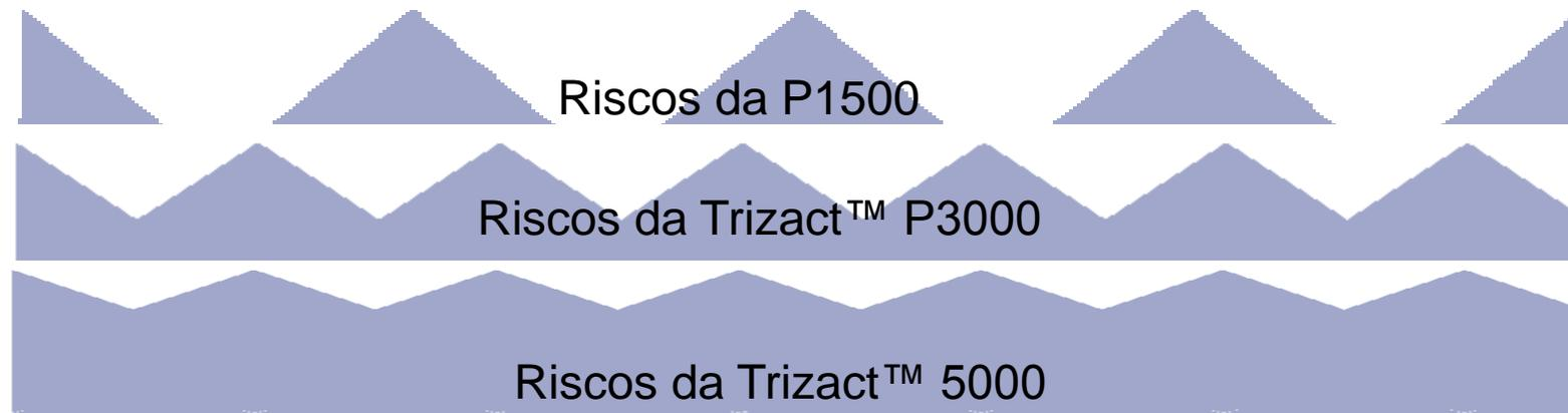
Devido o Trizact™ P3000 reduzir a profundidade dos riscos da lixa P1500 pela metade, o tempo total de polimento pode também ser cortado pela metade. AGORA com o Trizact™ 5000 reduzindo a profundidade dos riscos da P3000 pela metade, novamente o tempo de polimento pode ser cortado pela metade ou até eliminado!
